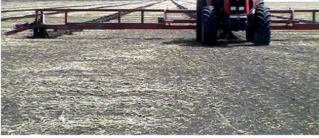
صورة 7. استخدام جهاز القيادة الذاتي لعمل خطوط التعليم.
