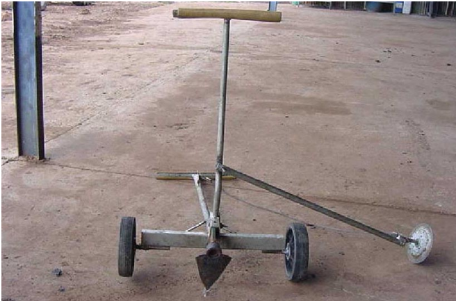
صورة 1. فاتحة السطور (Furrow opener) تُستخدم في نظام الزراعة بدون حرث تم تطويرها في آدي.
