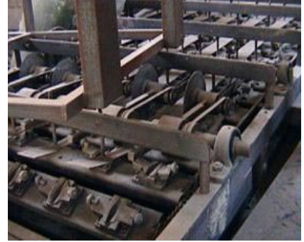
صورة 8. آلة طور التنفيذ لشق التمور وحشوها بالمكسرات وإعادة غلقها آلياً.
